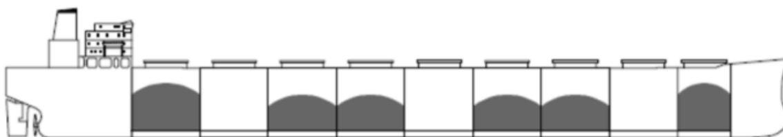
Slika 19 – “Blok” način krcanja tereta
