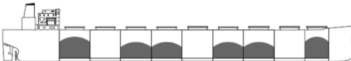
Slika 19 – "Blok" način krcanja tereta
