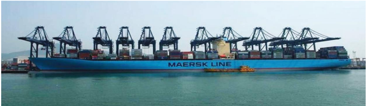
Slika 12.: Brod „Emma Maersk“ sa prikazom broja pretovarnih dizalica koji opslužuju brod da bi se minimaliziralo vrijeme boravka u luci [12]
