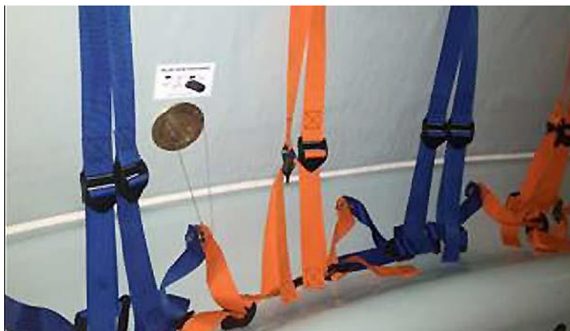
Slika 6. Sigurnosni pojas za potpuno zatvorenu brodicu za spašavanje
