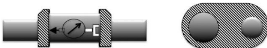
Slika 49. Mjerenje otklona u poziciji desno 90° (Izvor: https://mirmarine.net/stati-na-anglijskom/marine-engine/372-crankshaft )
