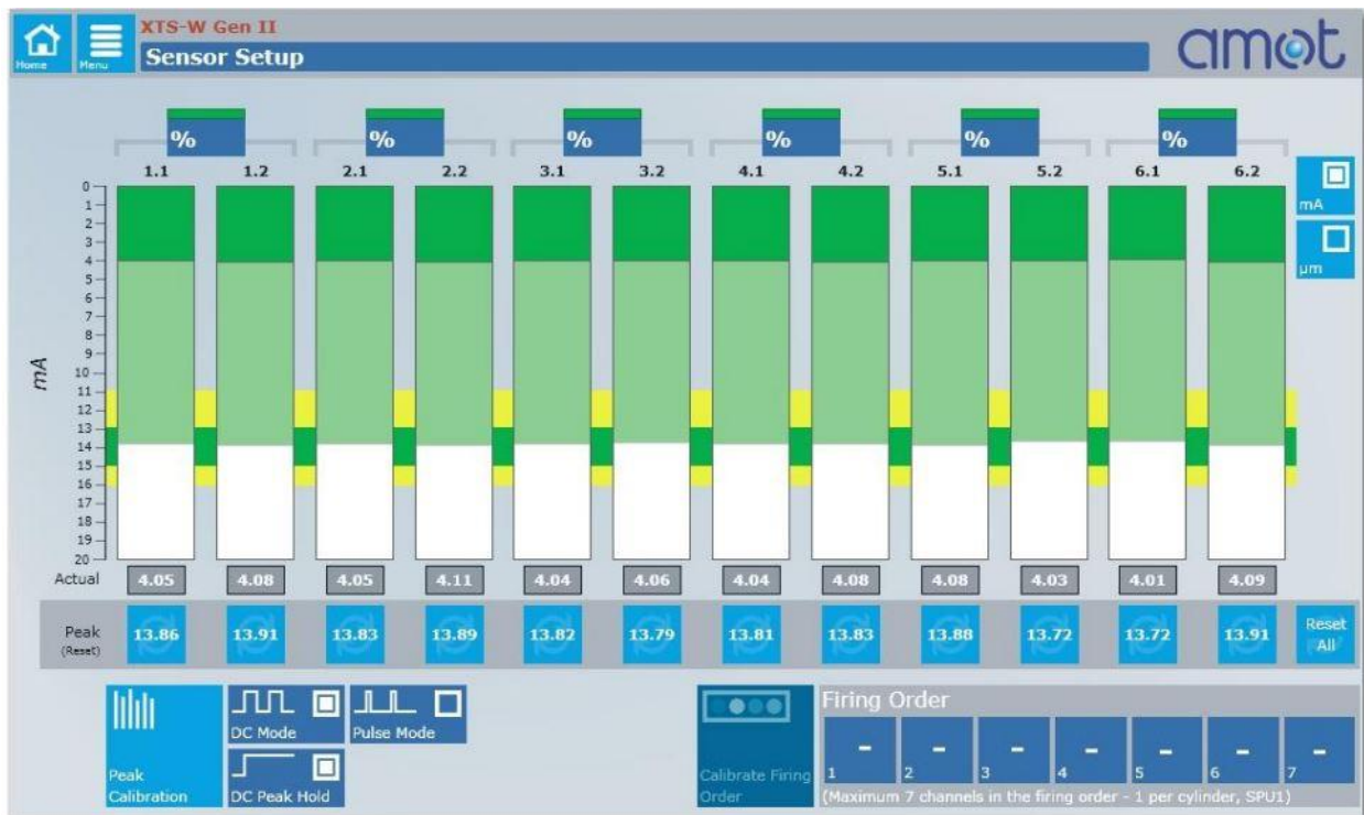
Slika 35. Prikaz zaslona nakon pravilnog spajanja senzora (Izvor: AMOT software manual)
