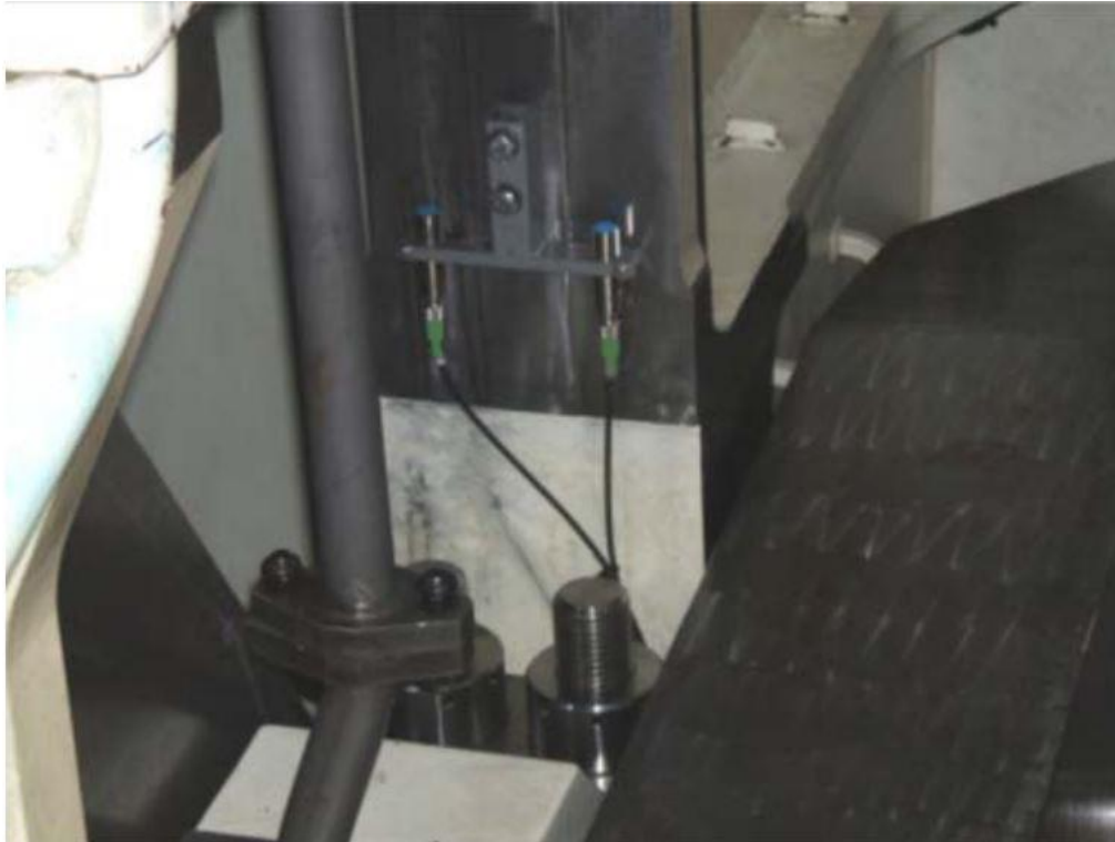
Slika 8. Prikaz ugradnje senzora (Izvor: AMOT system overview)
