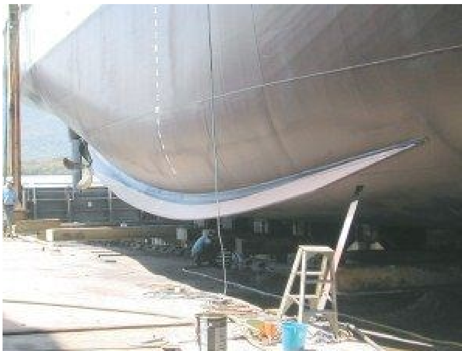
Slika 9. Prikaz kaljužne kobilice u dokovanju broda; Izvor [8].
