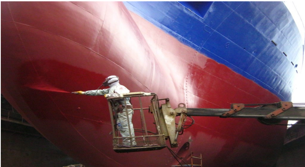
Slika 13. Nanošenje antivegetativno premaza na oplatu broda; Izvor [14]
