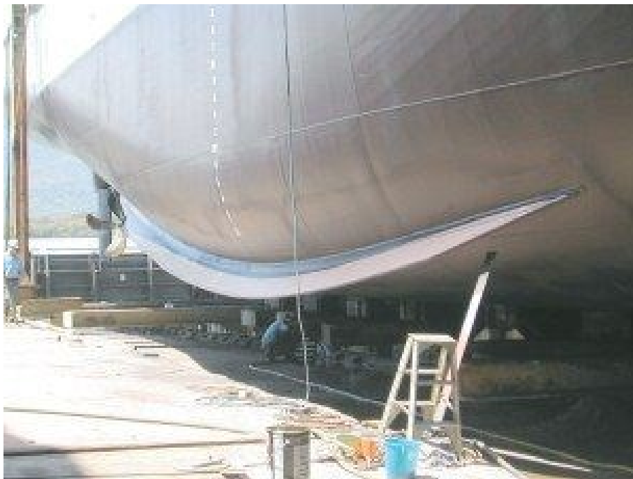
Slika 9. Prikaz kaljužne kobilice u dokovanju broda; Izvor [8].
