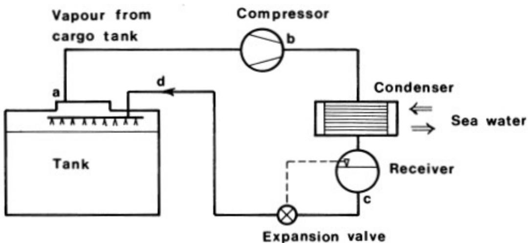
**Slika 7. Rashladni sustav s uređajem za izravno hlađenje [9]**
