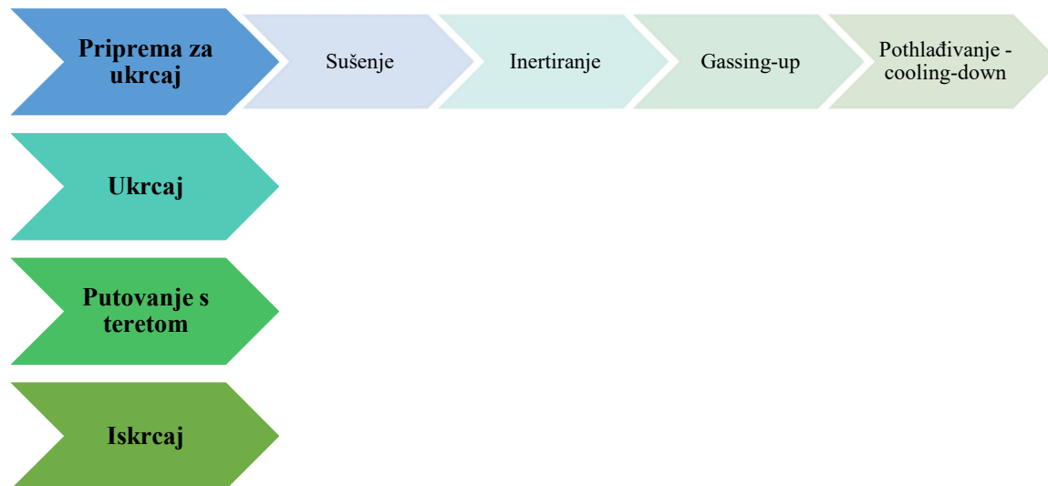
Slika 5. Faze prijevoza ukapljenog plina [7]
