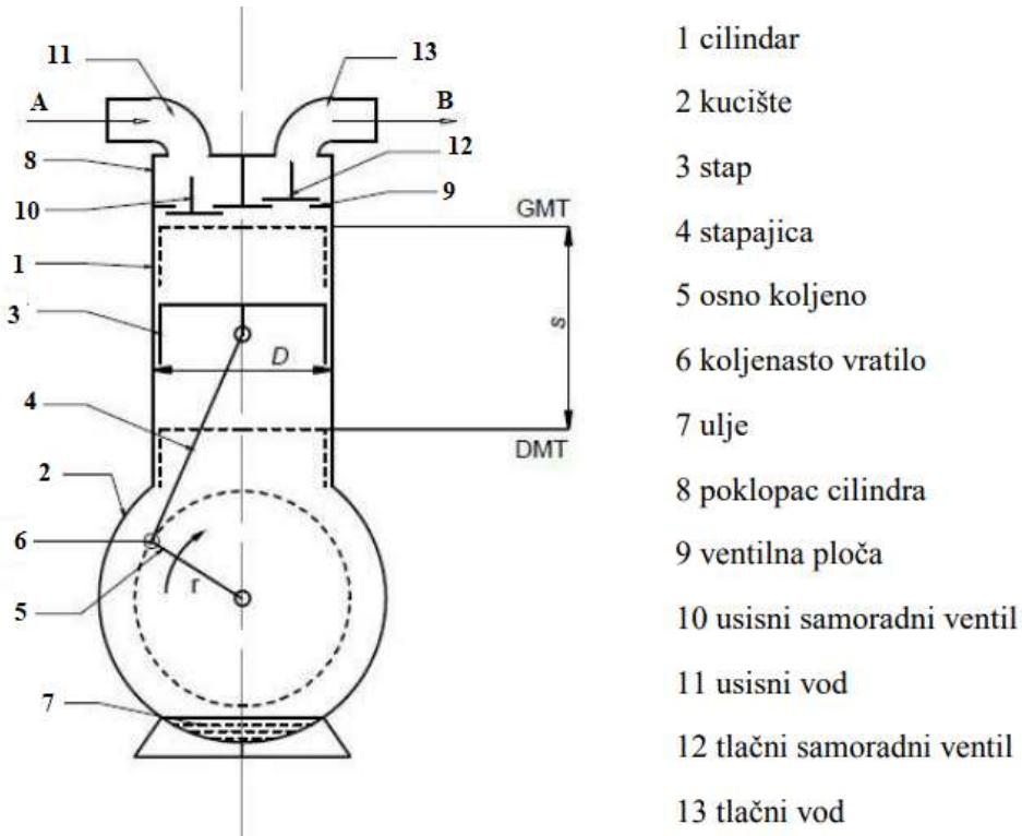
Slika 11. Dijelovi stupnog kompresora [17]
