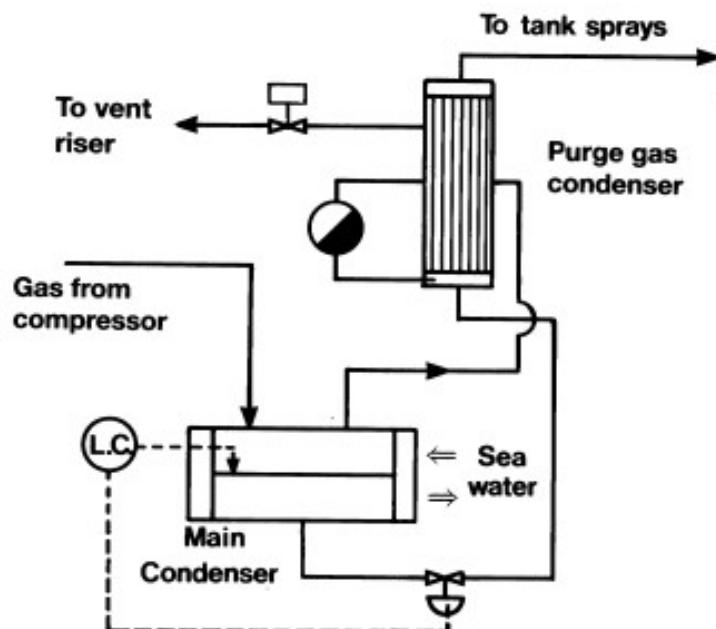
Slika 14. Sustav kondenzatora [10]
