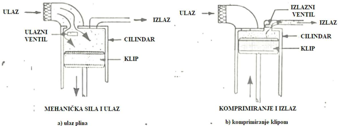
Slika 12. Princip rada stapnog kompresora [9]
