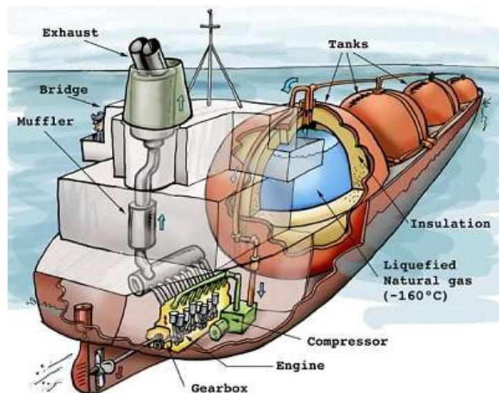
Slika 4. Tipičan izgled konstrukcije LNG broda [17]
