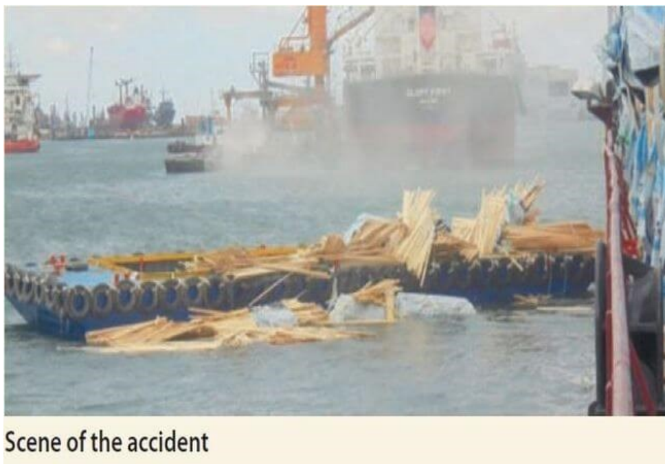
Slika 11. Primjer prevrtanja tereta sa broda u more
