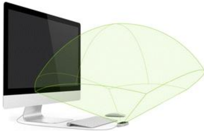
Slika 13. Raspon prepoznavanja ruka Leap Motion uređaja
