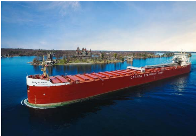
Slika 18. Brod namijenjen plovidbi isključivo velikim jezerima ( laker ).
