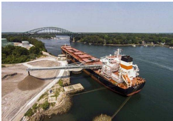
Slika 17. Brod samostalno iskrcava teret ( self unloader ).
