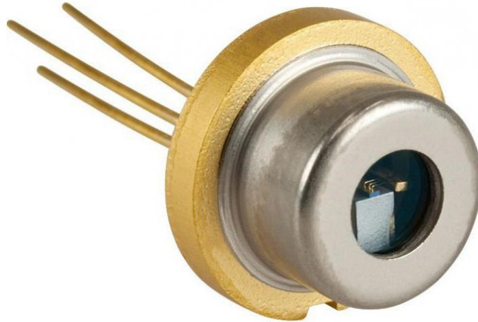
Slika 20. Prikaz poluvodičkog lasera – laserska dioda
