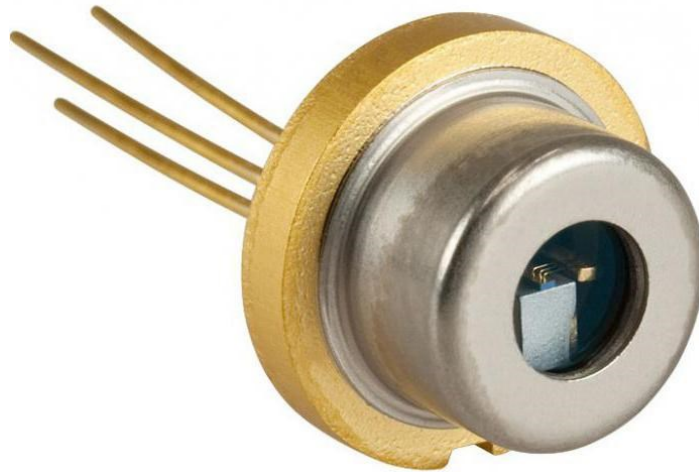
Slika 20. Prikaz poluvodičkog lasera – laserska dioda
