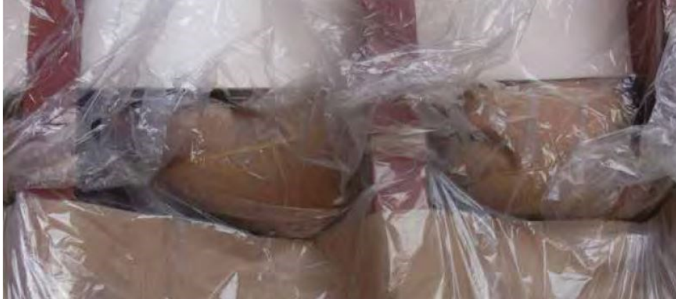
Slika 4. Piljevina u vrećama umetnuta na prijelazu između bočne oplata i donjeg bočnog tanka.
