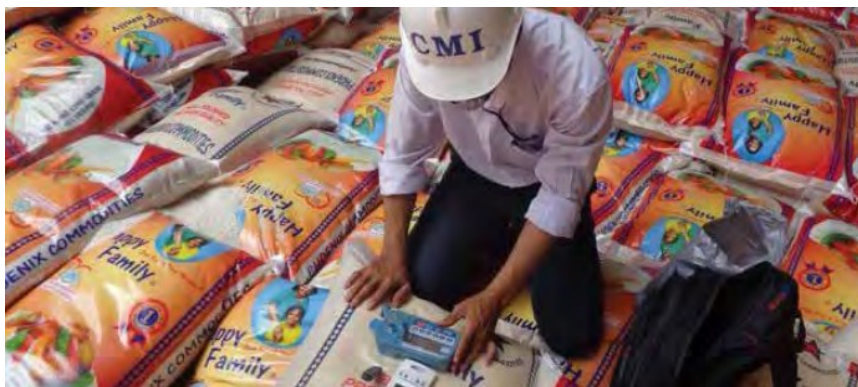
Slika 9. Inspektor tereta koji mjeri sadržaj vlage izravno iz vreće riže u skladištu tereta.
