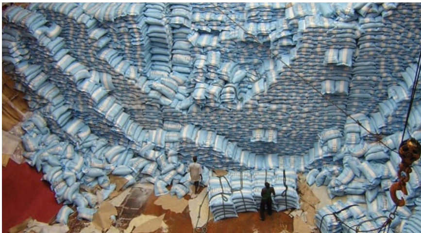
Slika 14. Nasilno izvlačenje donjih vreća može uzrokovati štete na teretu ali i ozljede slagača.
