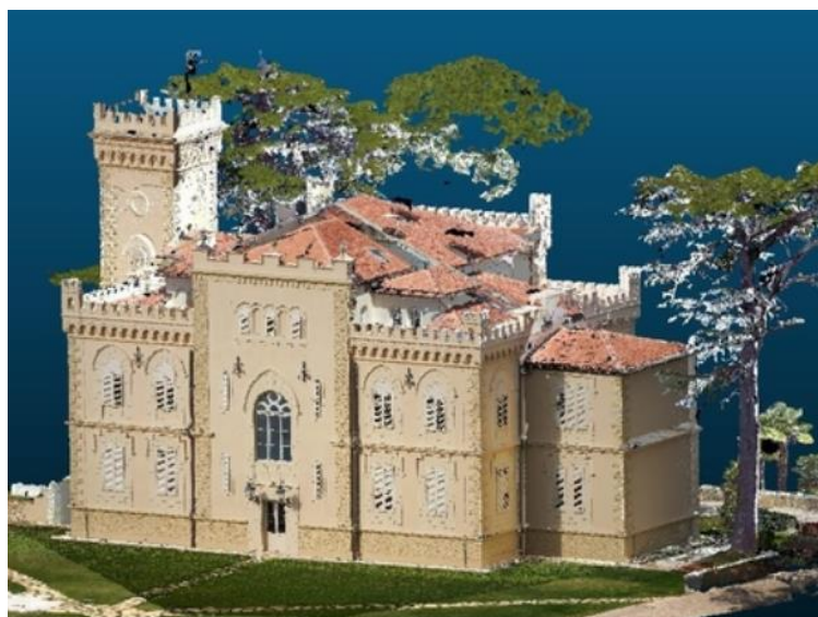
Slika 5. Oblak točaka dobiven isključivo iz fotografija iz zraka [10]
