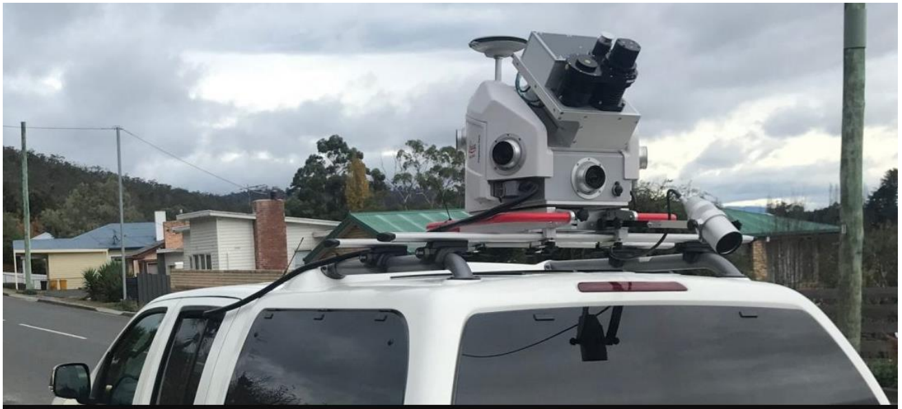
Slika 3. Primjer mobilnog MLS skenera [9]
