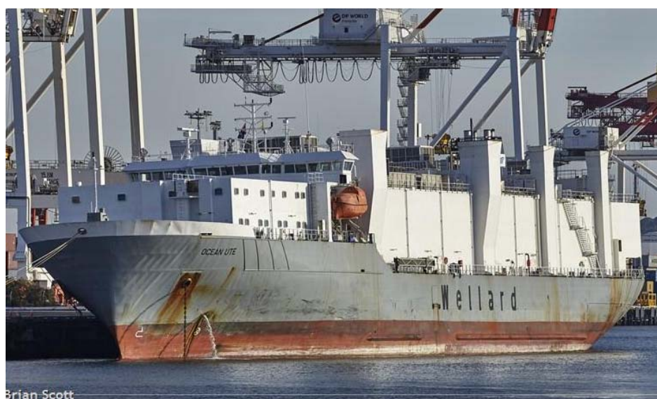
Slika 45. Brod sa zatvorenim štalama Ocean Ute [12]
