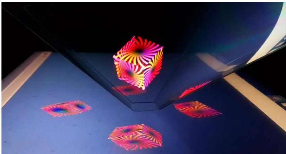
Slika 9 Primjer korištenja piramide za prikaz Pepperovog duha [61]
