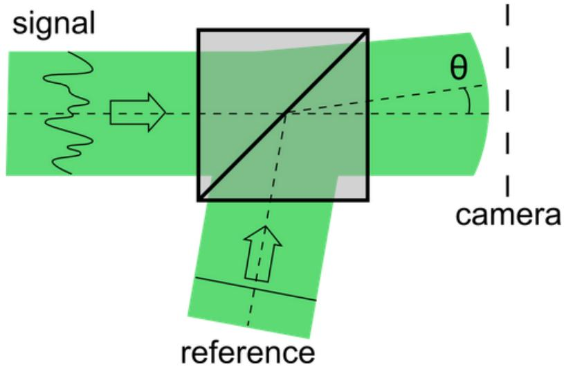
Slika 1 Shematski prikaz interreferometrijskog postavljanja za off-axis holograme [55]
