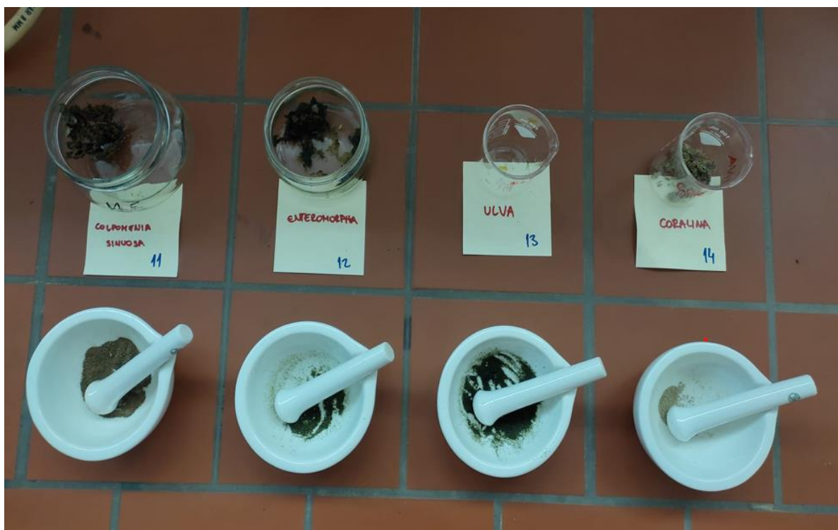
Slika 12. Usitnjavanje uzoraka algi nakon 24-satnog sušenja.
