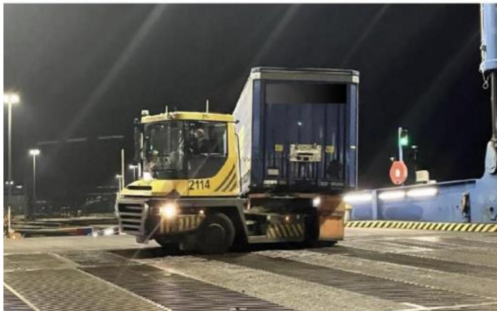
**Slika 12. Terminalni tegljač koji utovaruje poluprikolicu**
