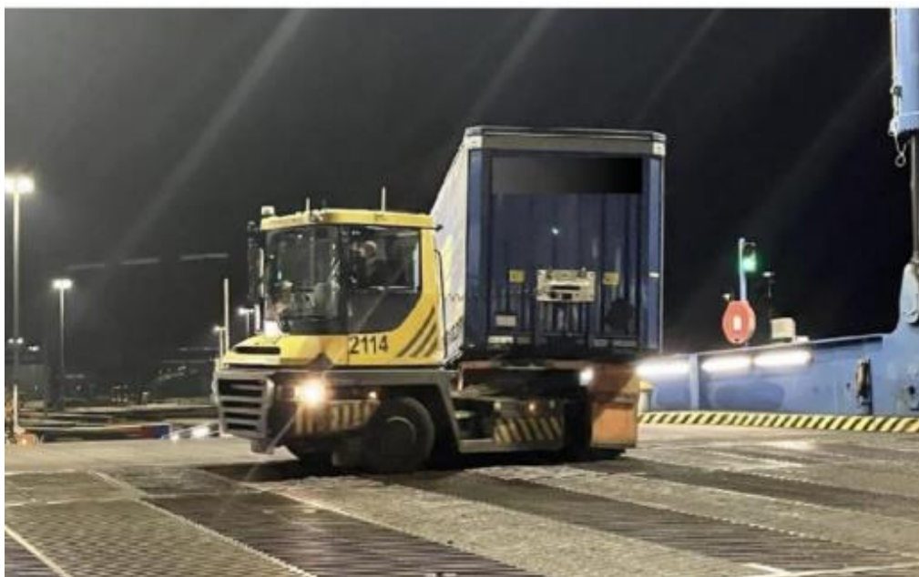
Slika 12. Terminalni tegljač koji utovaruje poluprikolicu
