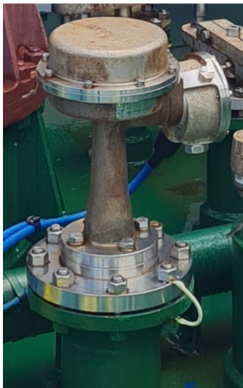
Slika 15. Radar za mjerenje razine tereta u spremniku; Izvor: arhiva autora
