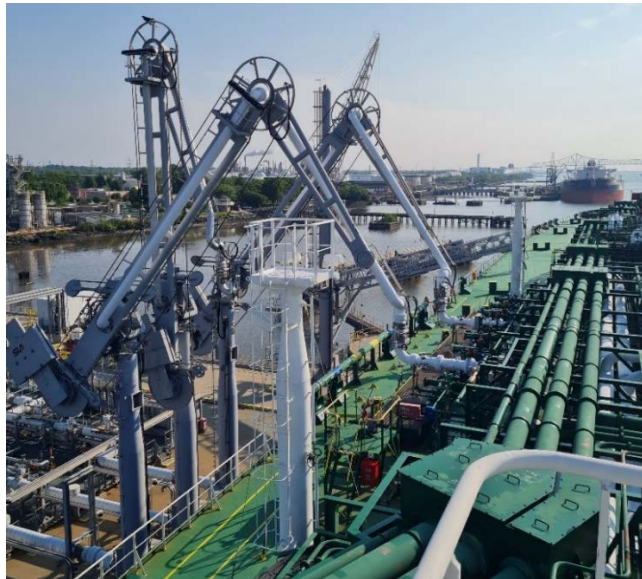
Slika 1. Zglobne ruke za manipulaciju teretom; Izvor: arhiva autora
