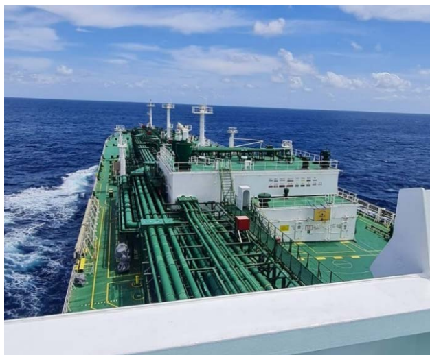
Slika 4. Cjevovodi na palubi LPG broda; Izvor: arhiva autora
