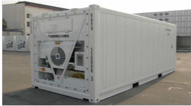
Slika 5. Hlađeni ISO kontejner.
