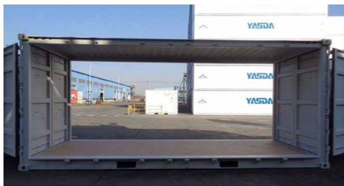
Slika 4. Kontejner s otvorenim stranicama.
