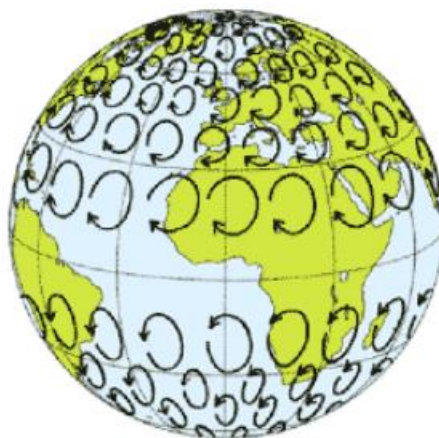
Slika 2. Shematski prikaz kretanja struja u djelovanju Coriolisovog učinka
