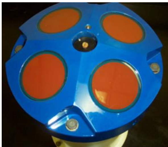
Slika 7. Glava ADCP senzora s četiri sonde
