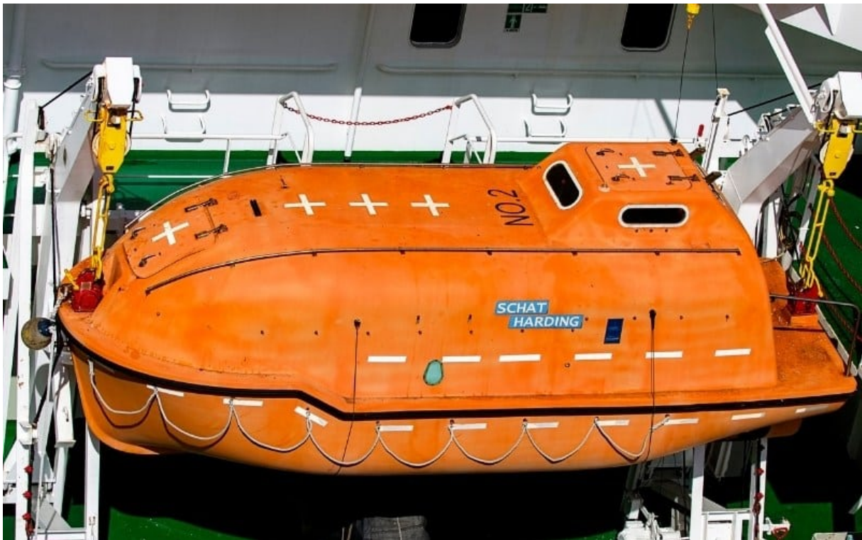
Slika 2.: Potpuno zatvorena brodica za spašavanje
