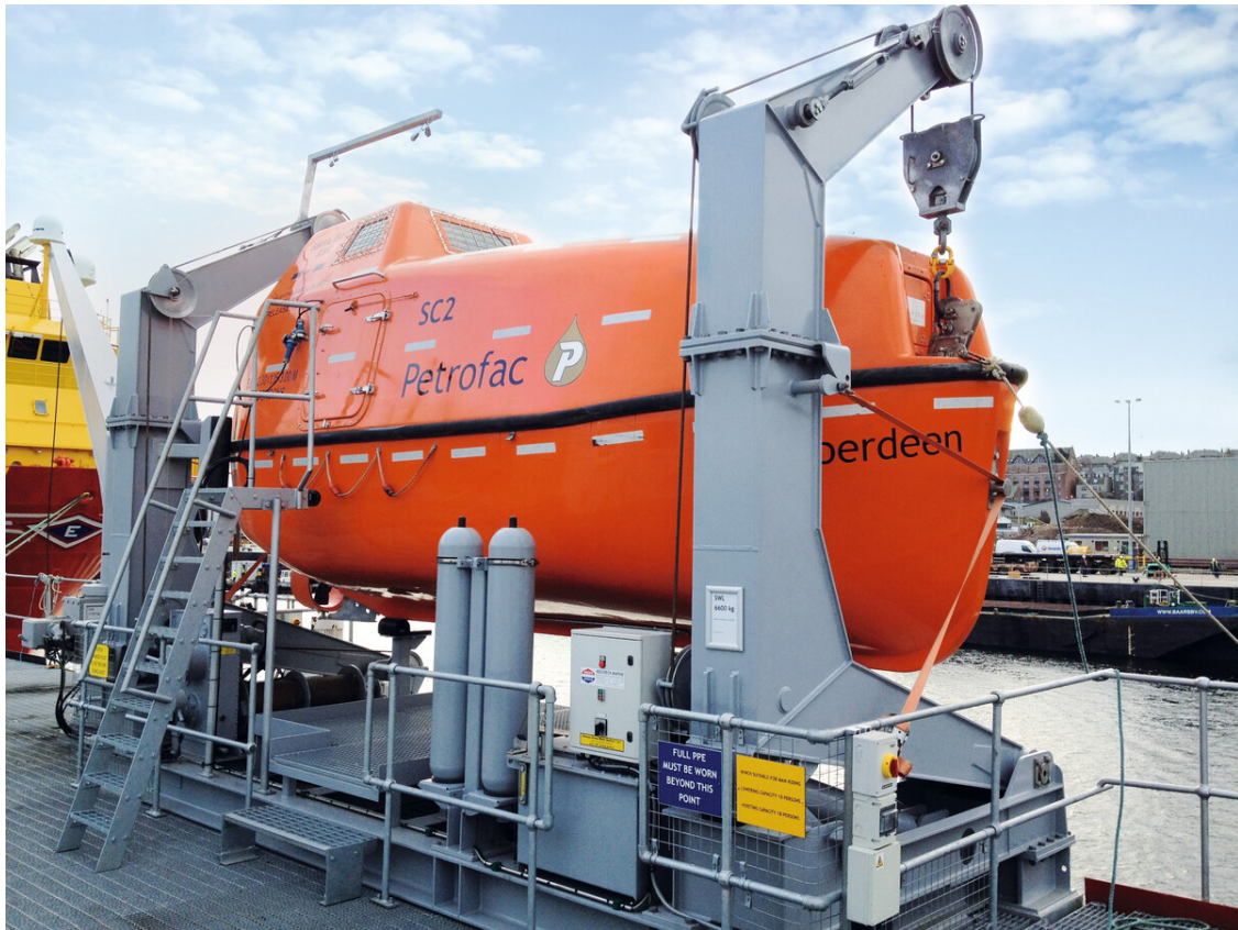
Slika 4.: Gravitacijska soha sa dvostrukim kranom
