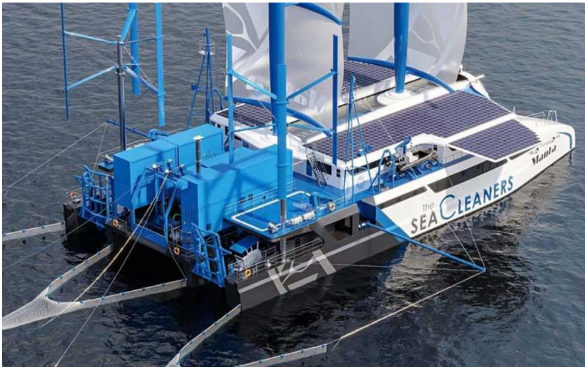
Slika 8. Autonomni brod za prikupljanje smeća MANTA 30
