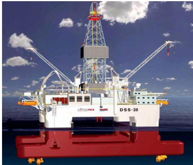
Slika 15: Pokretna odobalna jedinica za bušenje sa četiri azipod propulzora
