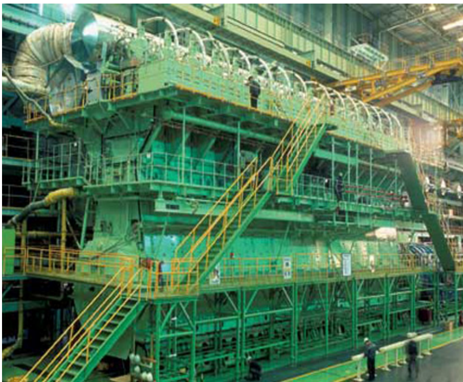
Slika 1. Dizelski motor tip Wärtsilä RT-flex96C prije same ugradnje na kontejnerski brod Emma Maers, koji je u vrijeme gradnje bio najveći brod takve vrste [7].
