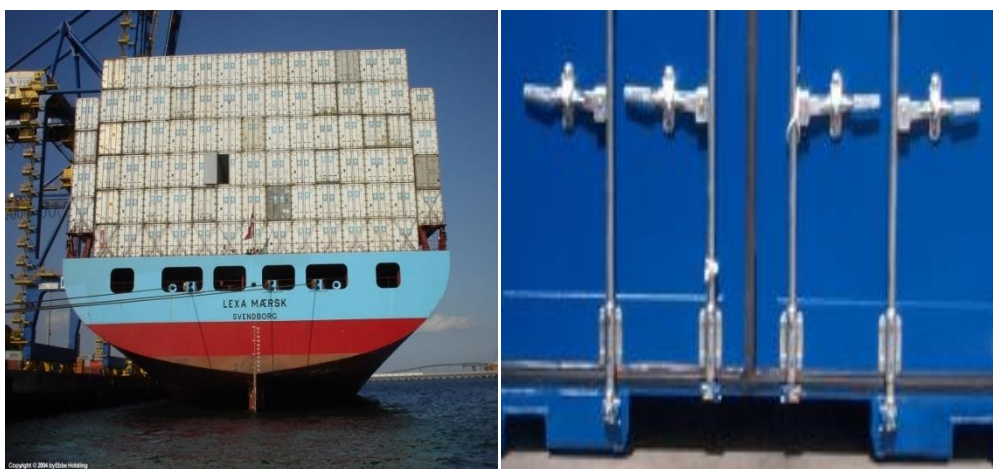
Slika 29. Neispravno zatvorena vrata(lijevo) ispravno zatvorena (desno)
