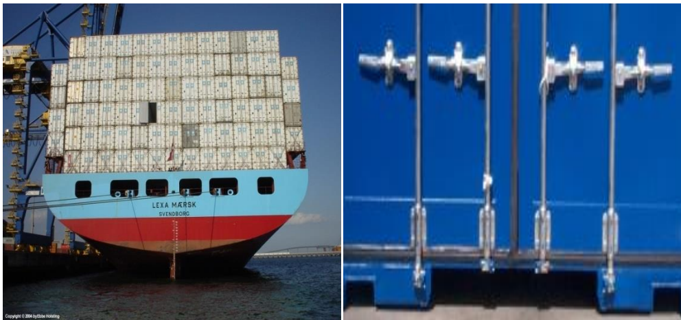
Slika 29. Neispravno zatvorena vrata(lijevo) ispravno zatvorena (desno)
