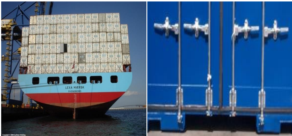
Slika 29. Neispravno zatvorena vrata(lijevo) ispravno zatvorena (desno)
