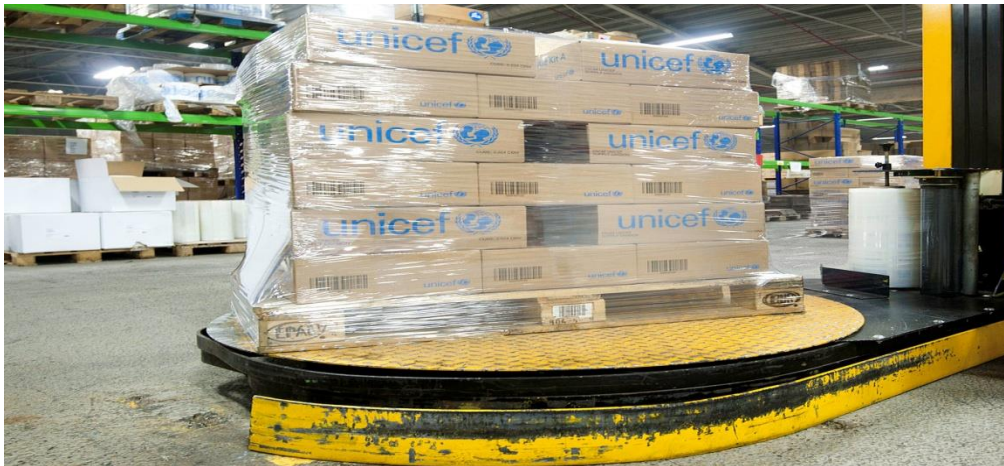
Slika 13. Osiguranje tereta na paleti sa polietilenskom folijom
