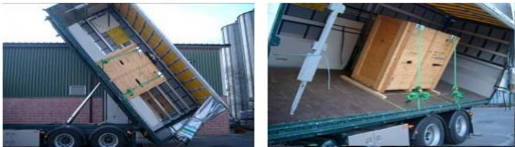
Slika 25. Osiguranje tereta protiv klizanja, naginjanja i prevrtanja
