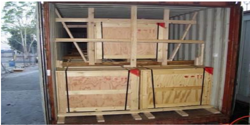
Slika 15. Prikaz pravilno osiguranog tereta u kontejneru
