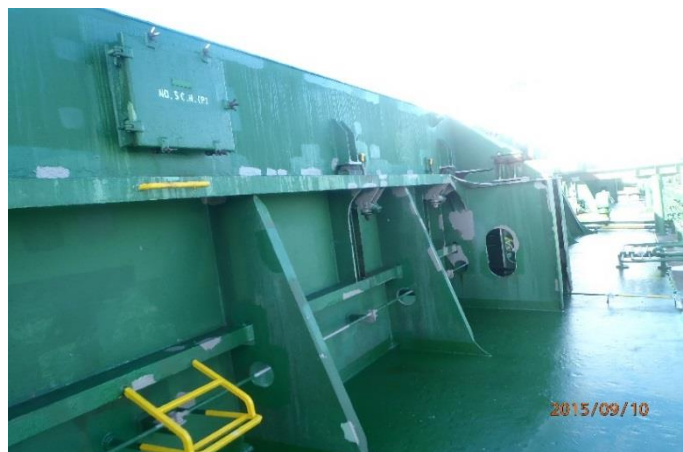
Slika 7. Održavanje ventilacije na poklopcima skladišta (privatni album, M/V Ataman)
