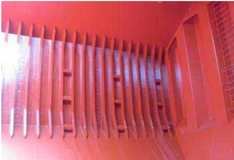
Slika 52. Bolnički čisto (Hospital clean) skladište
