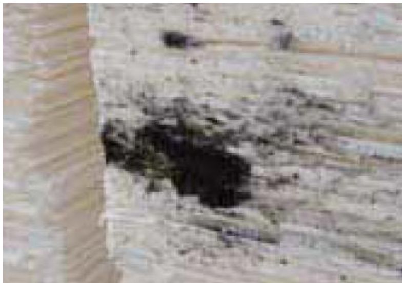
Slika 14. Pulpa sa mrljama od PETCOKE
