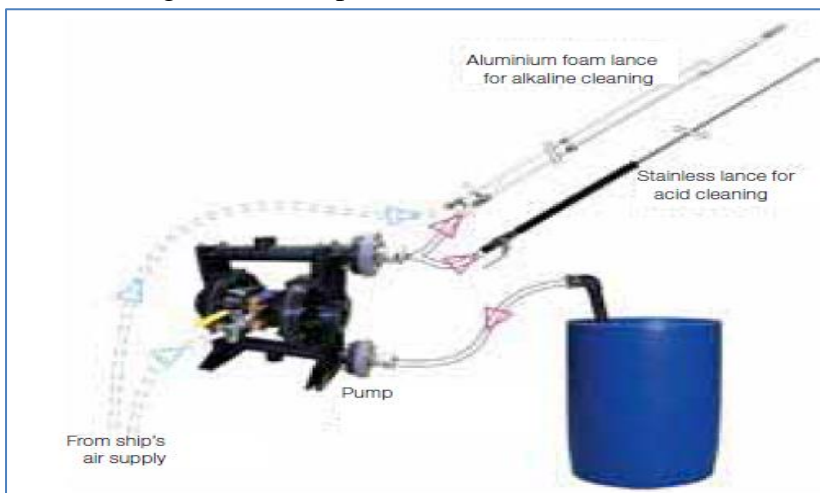
Slika 32. Specijalna oprema za čišćenje kemikalijama
