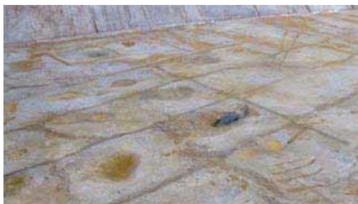
Slika 9. Potrebno je provjeriti udubljenja na pokrovu dvodna poslije iskrcaja i poslije čišćenja
