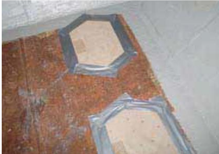
Slika 36. Kaljuže pokrivene sa grubom tkaninom (burlap) spremne za ukrcaj žitarica
