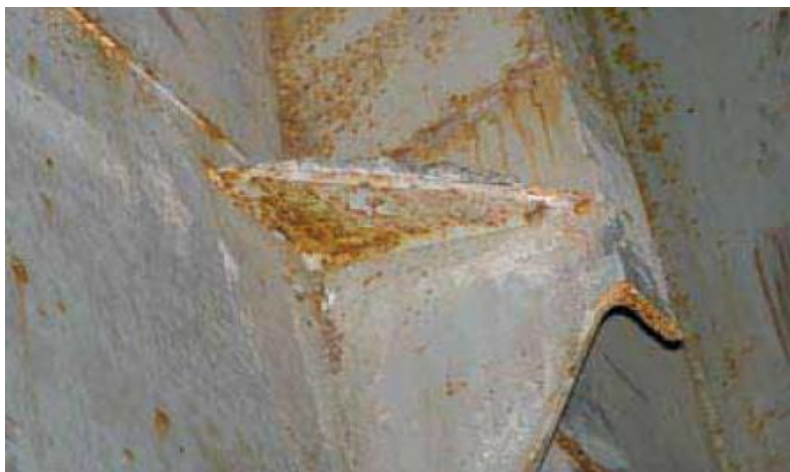
Slika 20. Ostaci prijašnjeg tereta će rezultirati da skladišta neće proći inspekciju za ukrcaj žitarica
