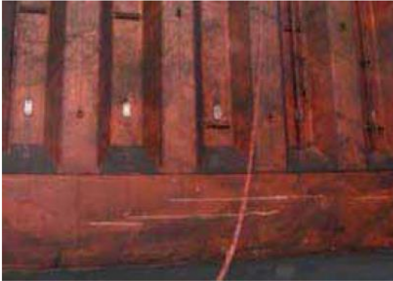
Slika 17. Da bi se skladišta prihvatila za neke terete, moraju biti "bolnički čista" (hospital clean)
