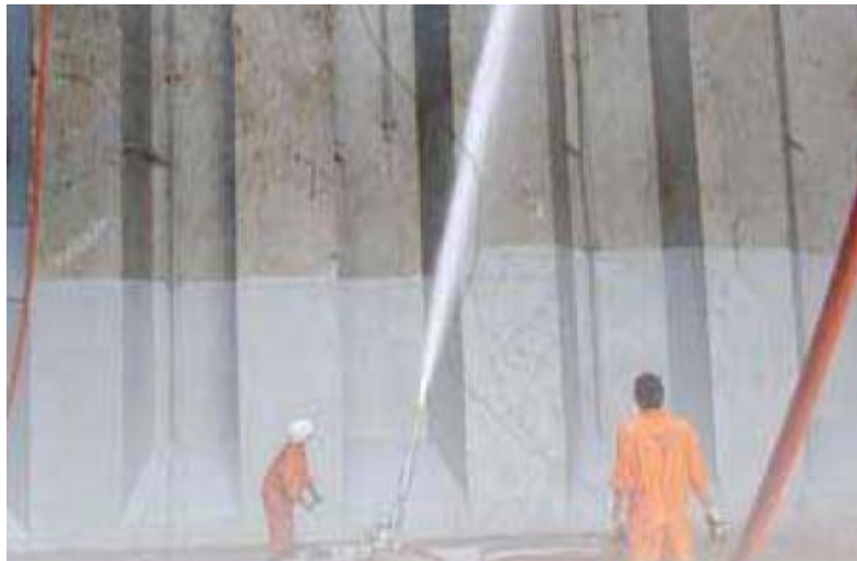
Slika 11. Čišćenje skladišta sa MAXI JET-om
