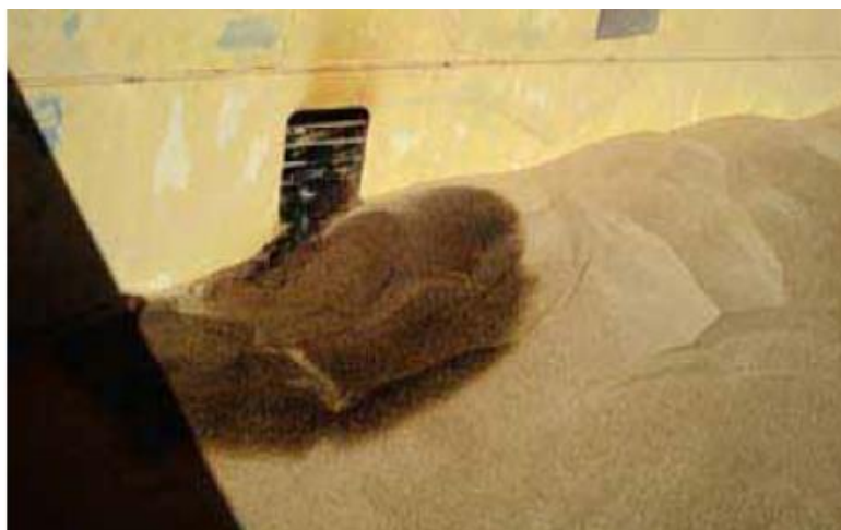
Slika 8. Svjetla u skladištima mogu prouzročiti požar
