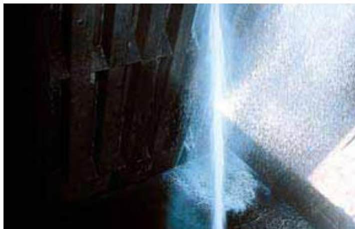
Slika 27. Stromme maxi gun omogućuje čišćenje velikom snagom sa poklopca dvodna
