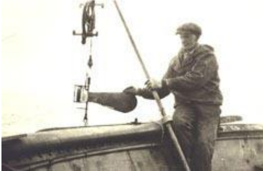
Slika 7. Puštanje mjerača struje na obalama Aljaske 1920. godine; Izvor: http://skola.gfz.hr/slike/m4_slika2.jpg (zadnji pogled: 30.4.2018.)
