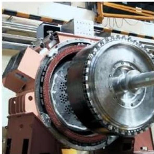
*Slika 4. permanentno uzbudjeni sinkroni motor*
