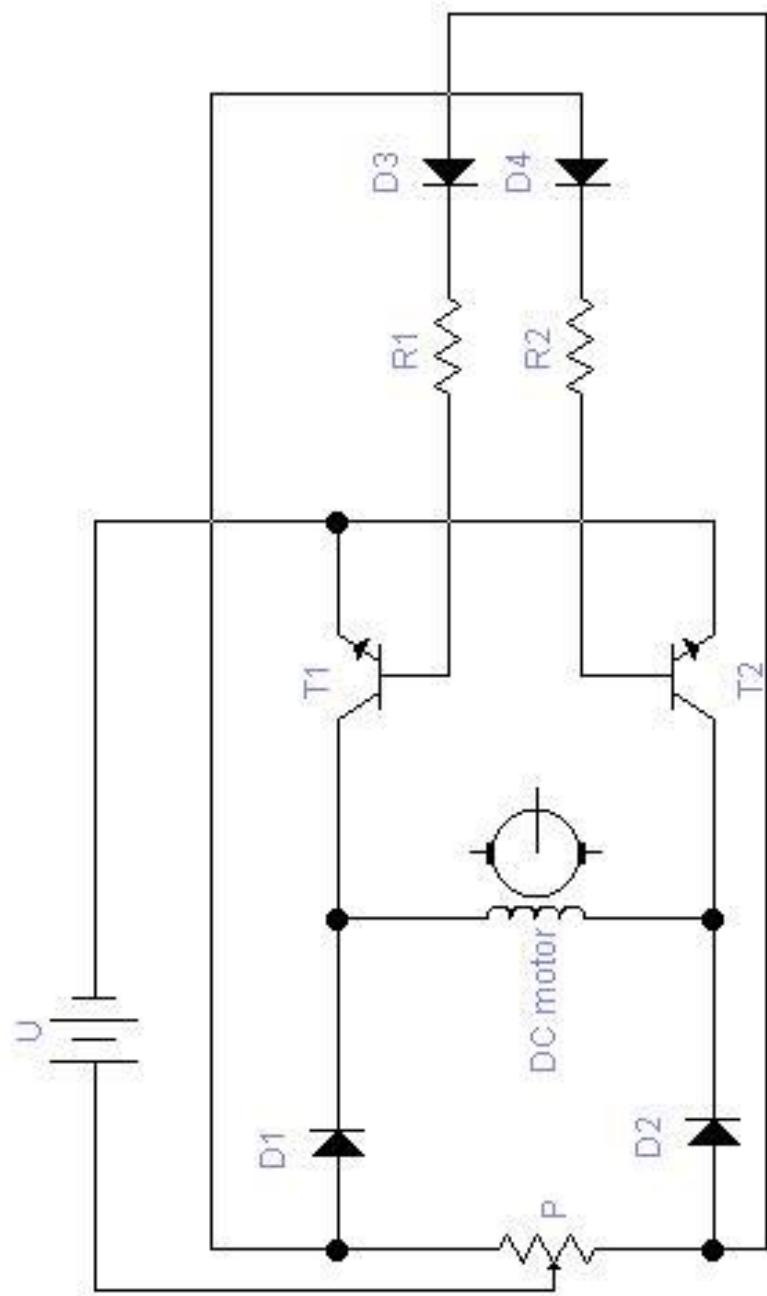
Slika 5. Shema promjene smjera vrtnje DC motora
