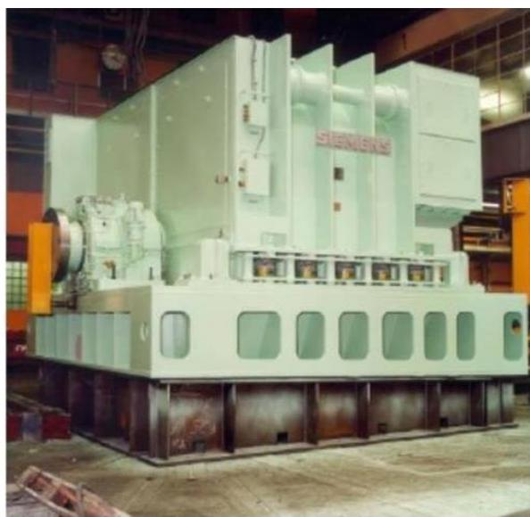
*Slika 3. Sinkroni propulzijski motor*
