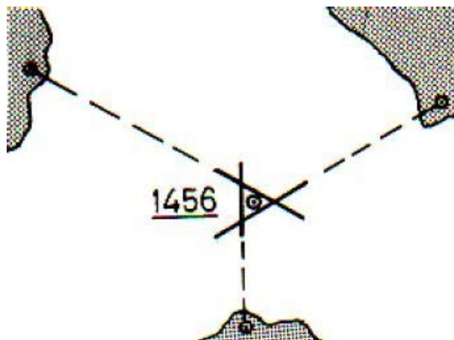
**Slika 19. Pozicija određena s tri azimuta [8]**
