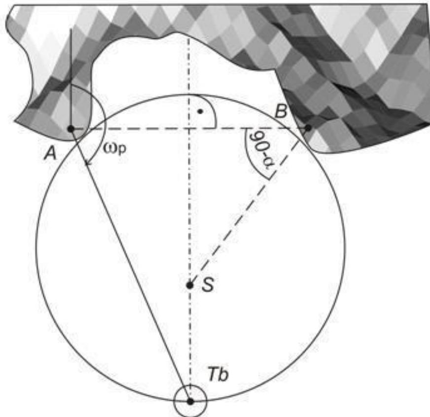
Određivanje položaja broda pomoću azimuta i horizontalnog kuta
