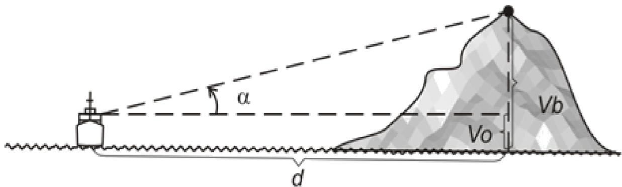
Udaljenost broda od objekta na osnovu azimuta i vertikalnog kuta
