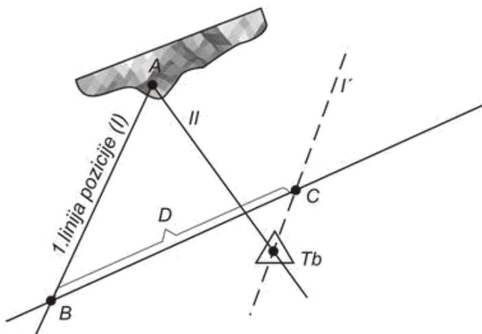
Slika 8. Pozicija određena mjerenjem dvaju azimuta [8]
