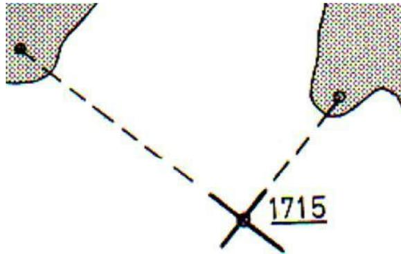
Slika 14. Pozicija određena sa dva azimuta istovremeno [8]
