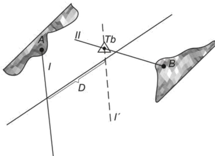
Slika 10. Pozicija određena s dva azimuta na dva objekta
