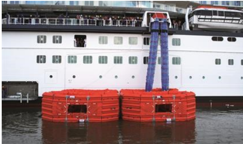
Slika 7. Sustavi za brzo napuštanje broda-pneumatski tobogani
