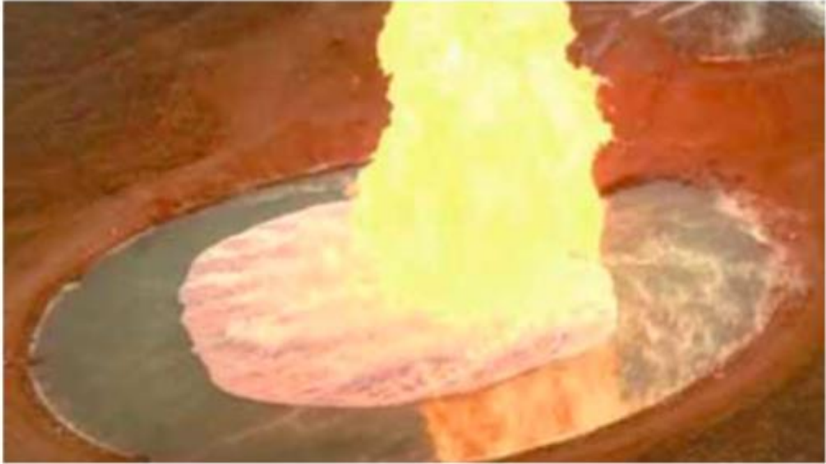
Slika 8. Požar lokve LNG-a [15]
