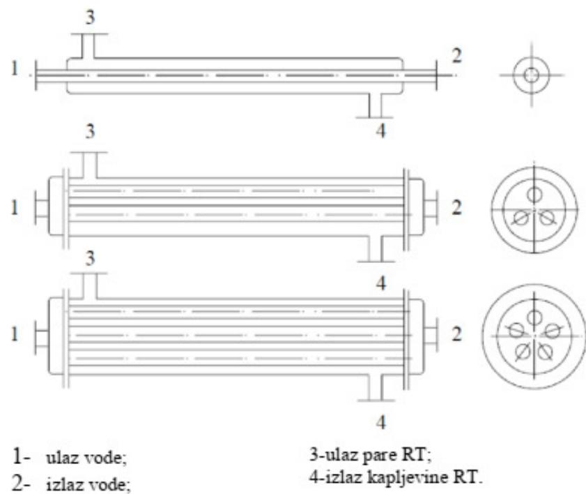
Slika 14. Protustrujni kondenzator
