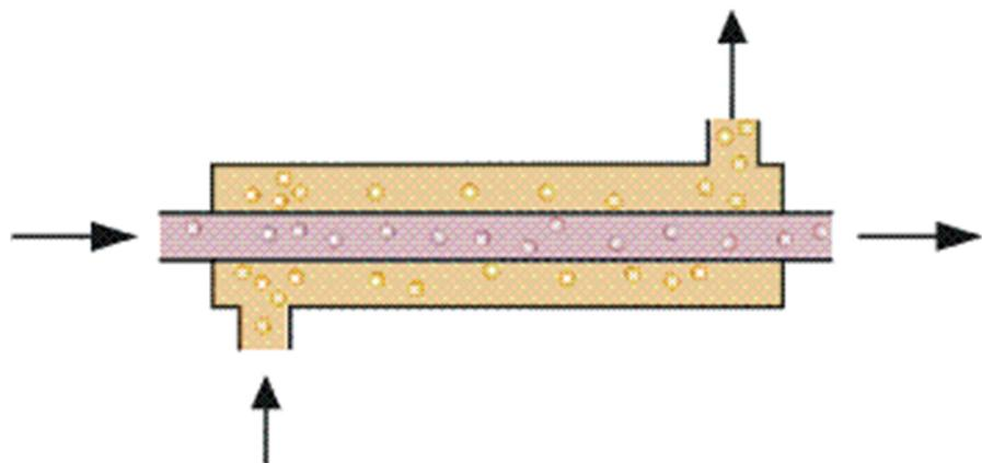
Slika 7. Istosmjerni izmjenjivač topline
