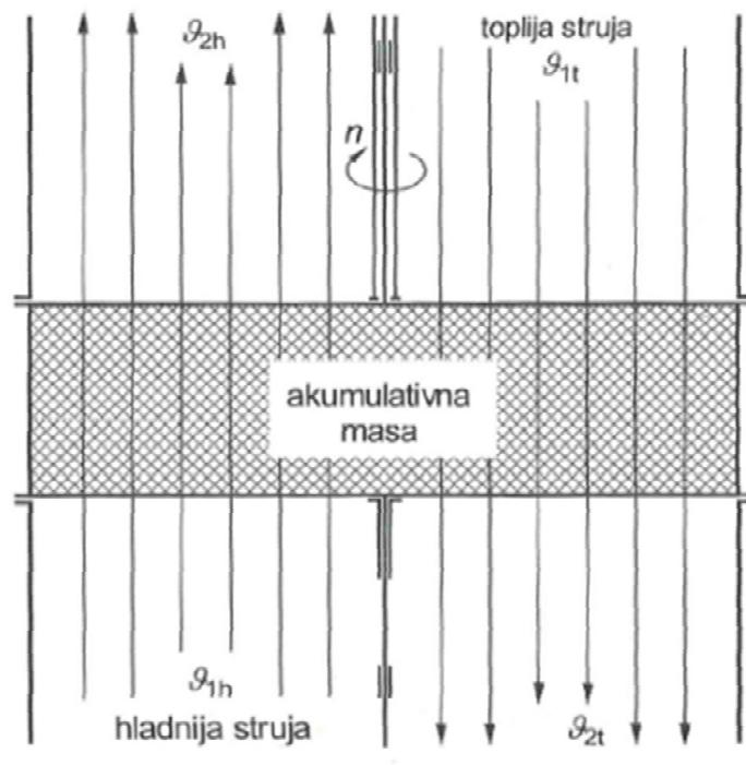
Slika 3. Shematski prikaz regenerativnog toplinskog aparata
