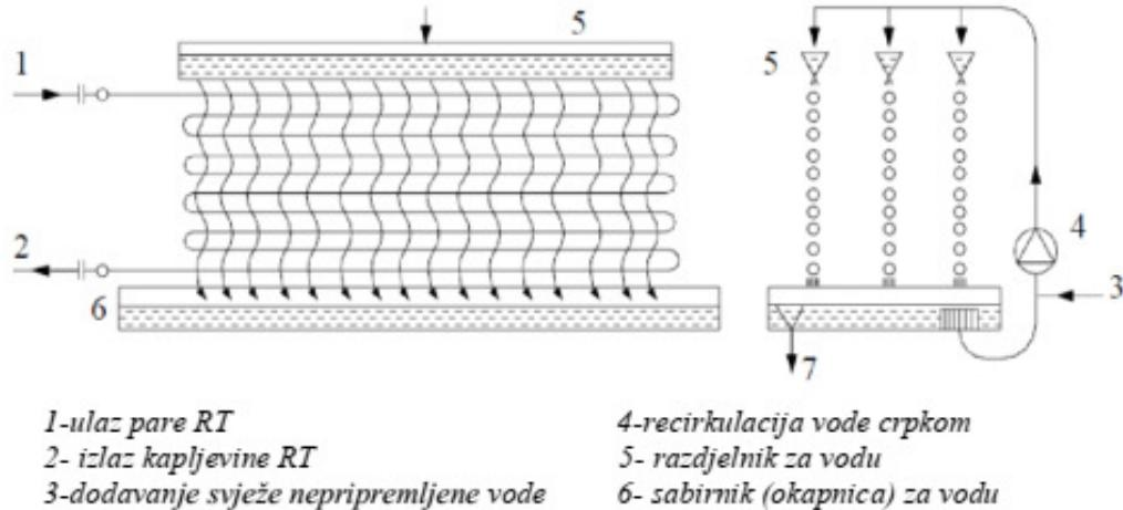
Slika 17. Atmosferski kondenzator
