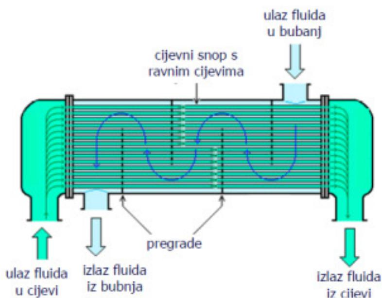
Slika 5. Cijevni izmjenjivač topline Shell and Tube
