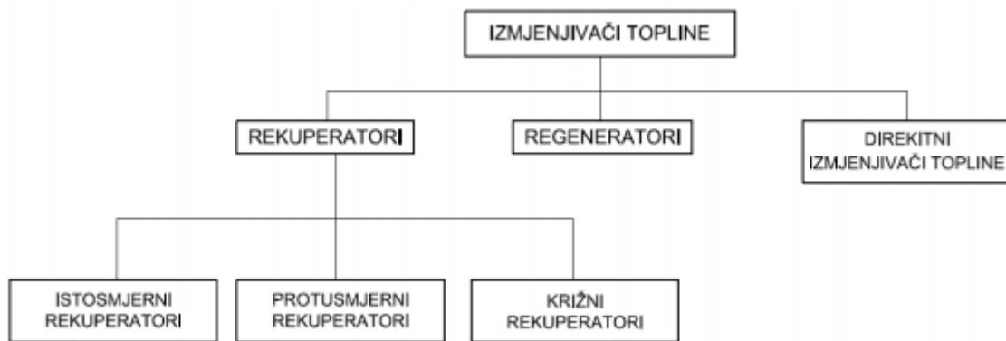
Slika 1. Načelna podjela izmjenjivača topline
