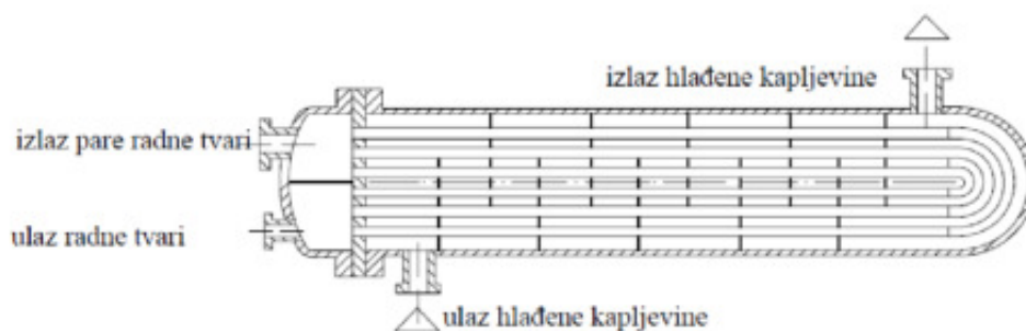
Slika 22. Isparivač za hlađenje kapljevine sa suhim isparivanjem i cijevnim snopom
