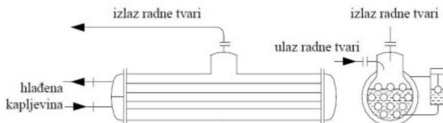
Slika 20. Potopljeni isparivač s cijevima u plaštu
