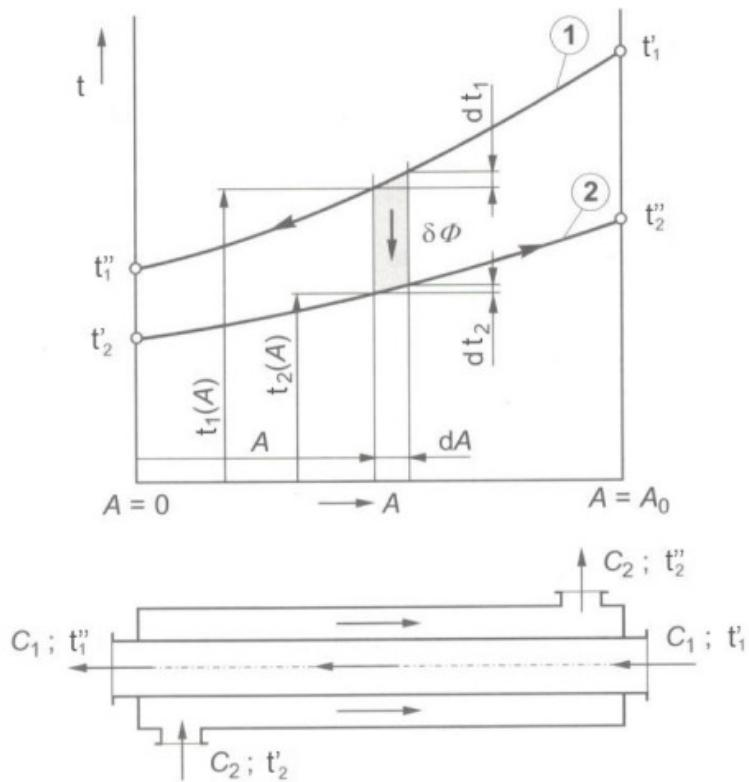
Slika 10. Temperaturni tok struja uzduž protustrujnog izmjenjivača topline
