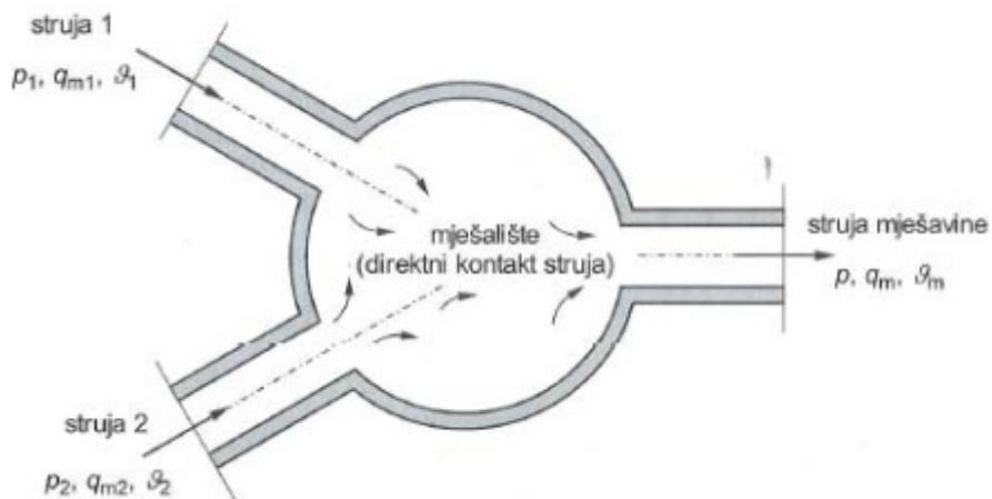
Slika 4. Direktni izmjenjivač topline
