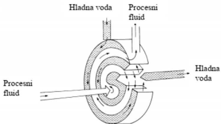
Slika 6. Spiralni pločasti izmjenjivač topline
