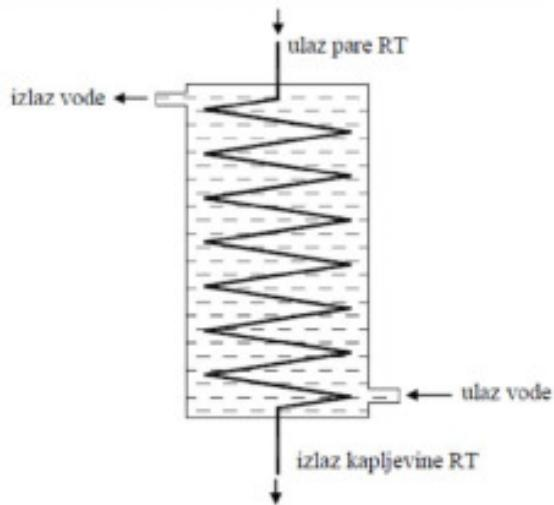
Slika 13. Kondezator sa cijevnom zavojnicom u bubenju
