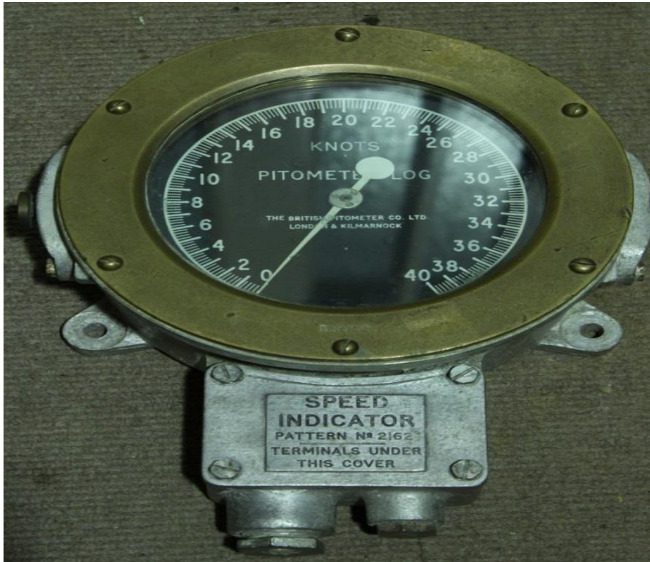
Slika 4. Manometar (hidrodinamički brzinomjer)
