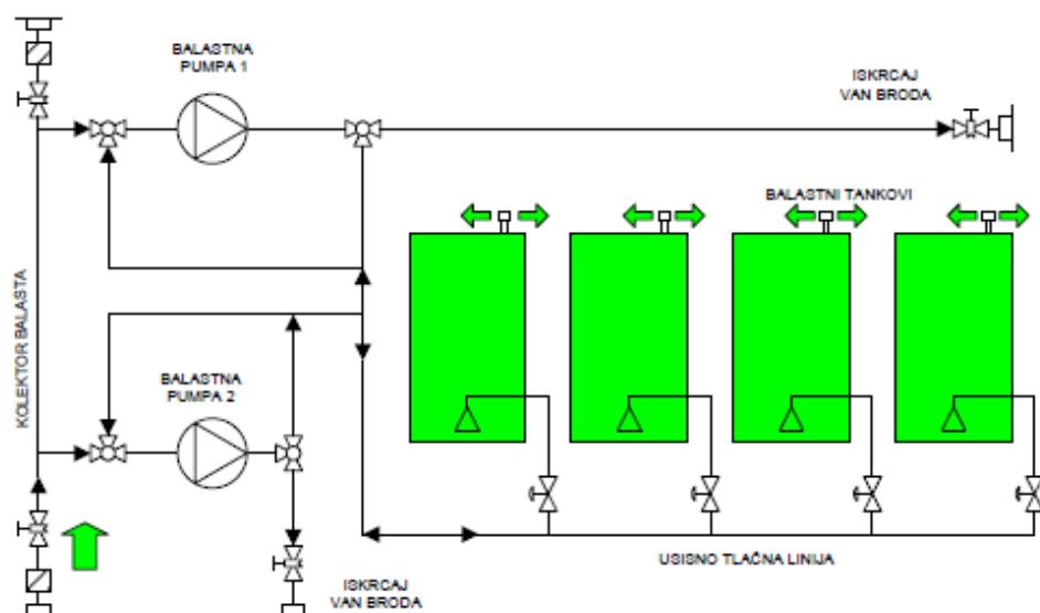
Slika 8 Metoda kontinuiranog ispiranja
