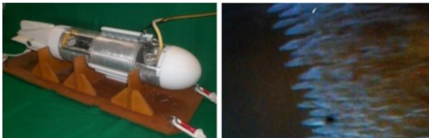
Slika 23 Tegljena istraživačka podmornica i tok zraka ispušten iz rasprskavača (preuzeto: https://www.mhi.co.jp/technology/review/pdf/e521/e521050.pdf )
