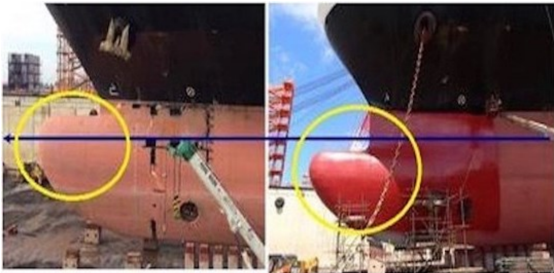
Slika 5 Izmjena konstrukcije pramčanoga bulba (preuzeto:
