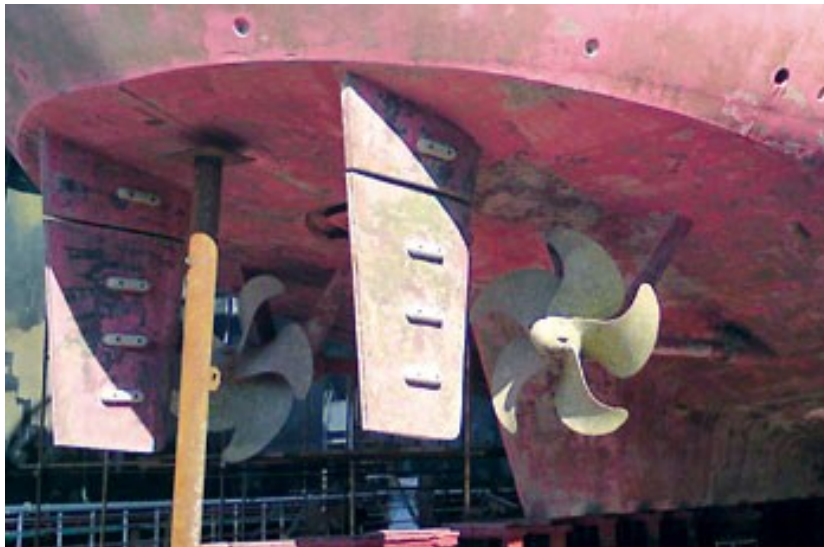
Slika 14 Primjer cink protektora na brodu (preuzeto: burza nautike)
