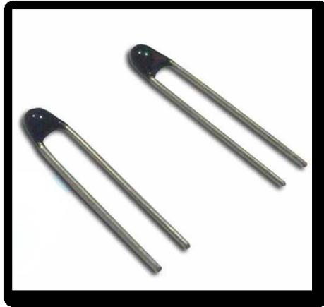
Slika 13. Poluvodič termorezistora s kuglicom [13]
