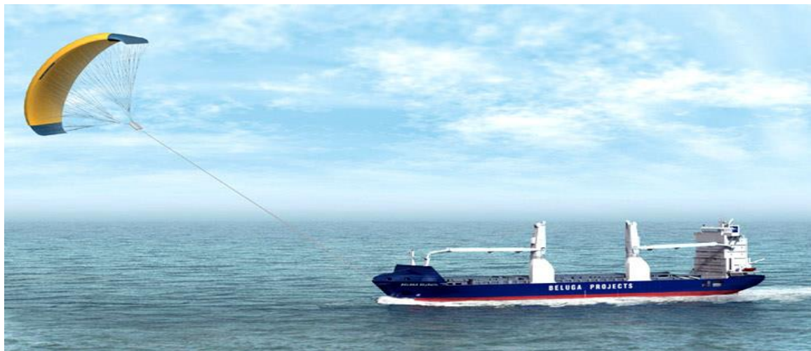
Slika 8. Prikaz broda u trenutku korištenja skysailsa [8]
