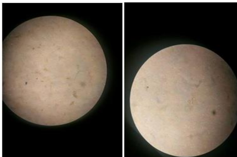
Slika 20. Uzorci tkiva razgrađenog u vodikovom peroksidu na 60°C
