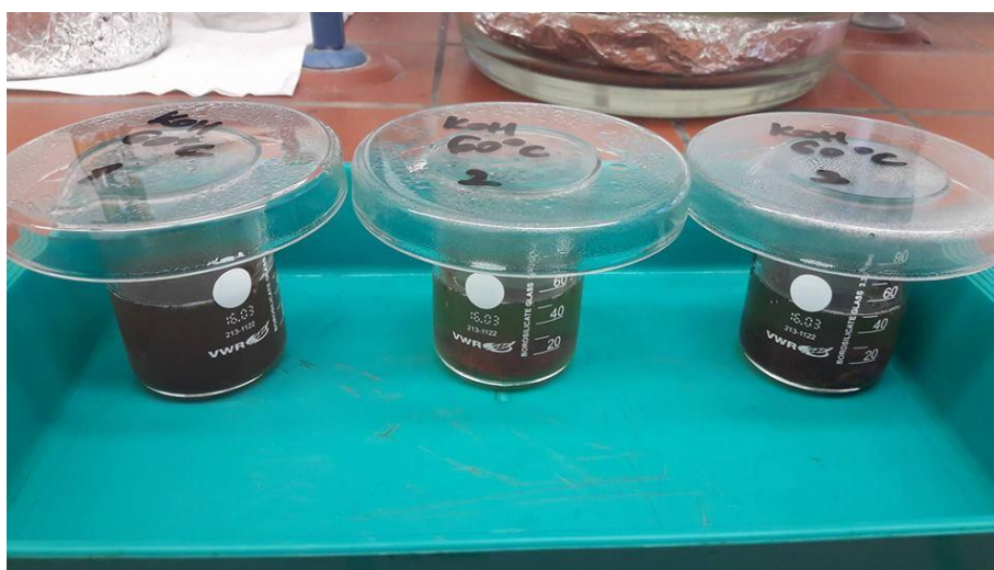
Slika 14. Uzorak u kalijevoj lužini na 60°C nakon 15 minuta. Promjena boje u smeđu.
