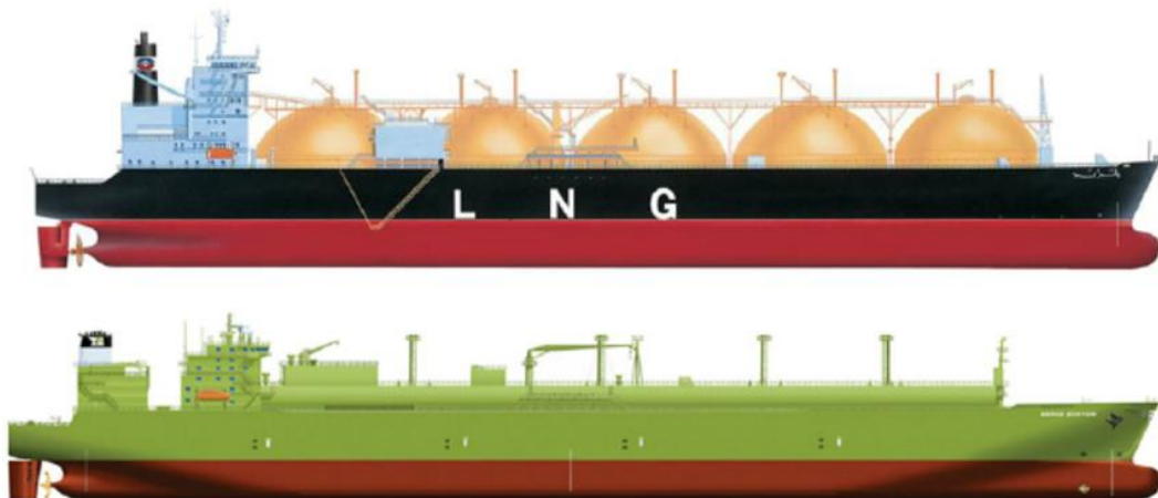
Slika 2. Glavni tipovi LNG tankera sferični tankeri (gore) i membranski tankeri (dolje) [8]
