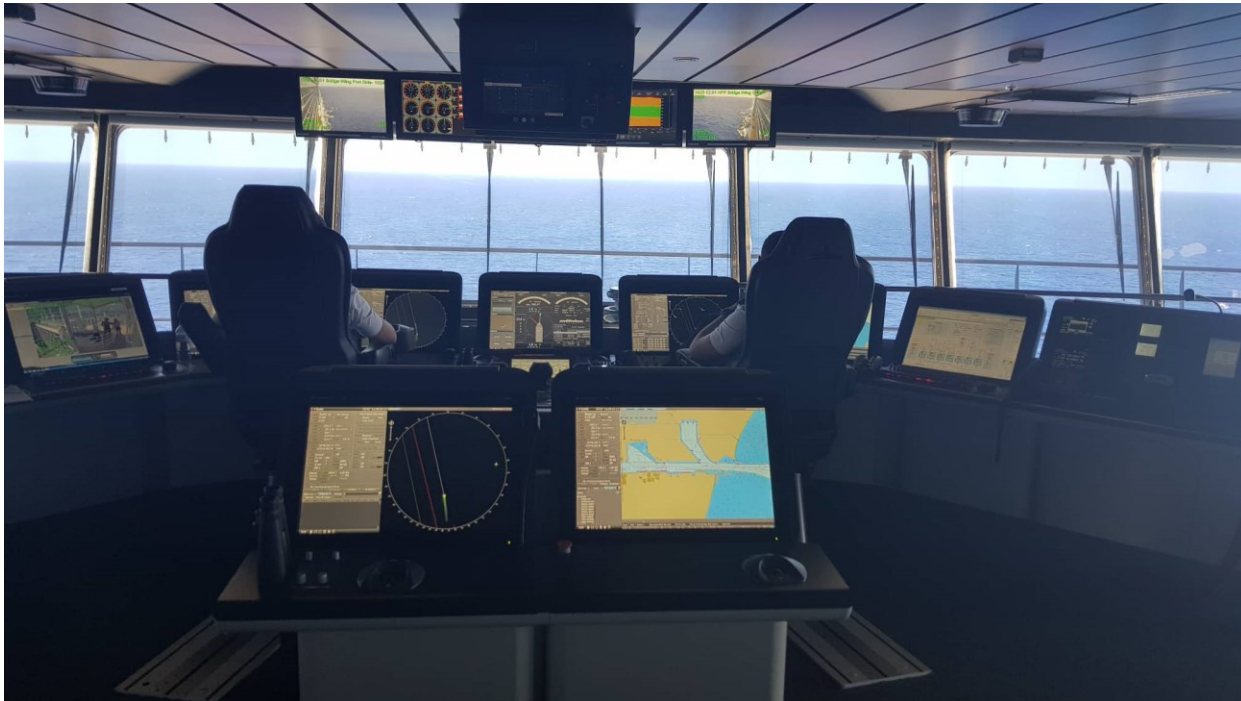
Slika 12. Vidljivost s pozicijemjesta upravljanja sa svim dostupnim uređajima za navigaciju, tzv. INS ( Integrated Navigational System )
