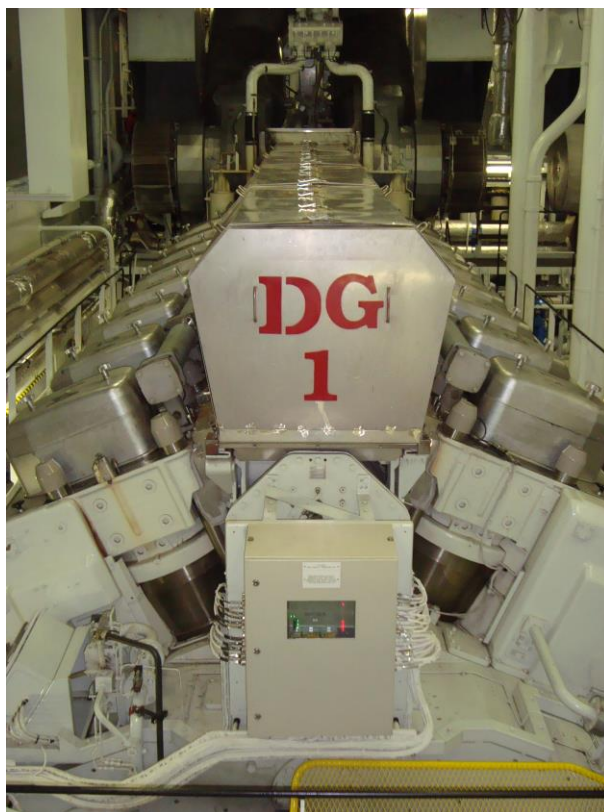
Slika 1.3: Oasis of the Seas , Dizel Generator Br.1, dizelski motor
