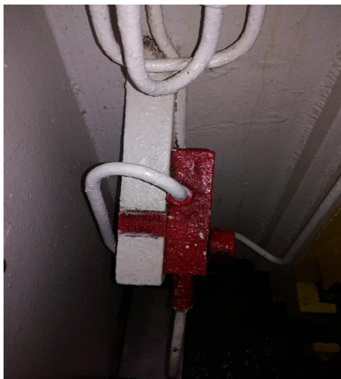
Slika 17. Ručka za otvaranje/zatvaranje vodonepropusnih kliznih vrata pomoću hidraulike na putničkom brodu „Berlin“
