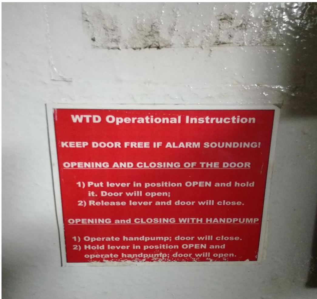
Slika 16. Upute za korištenja vodonepropusnih kliznih vrata pomoći hidraulike i ručno na putničkom brodu „Berlin“
