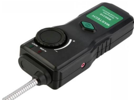
Slika 11. Ručni detektor plina.
