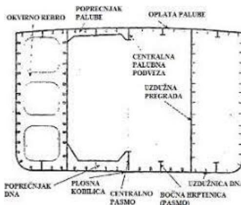
Slika 2. Poprečni presjek tankera na glavnom rebru.
