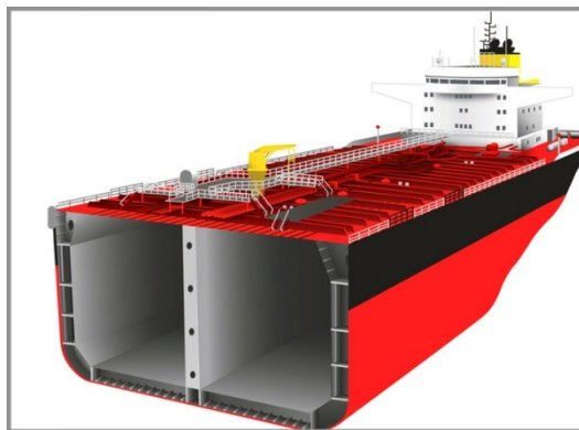
Slika 3. Tanker za prijevoz ulja s dvostrukim trupom i dnom.
