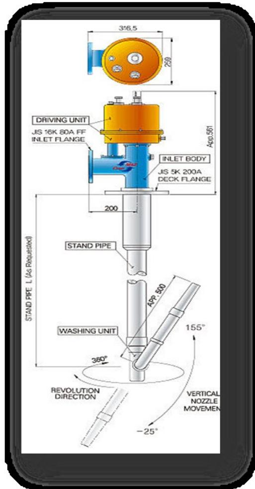
Slika 9. Stroj za pranje tankova s jednostrukom mlaznicom.
