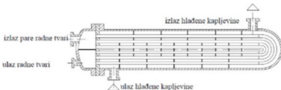
Slika 26. Isparivač za hlađenje kapljevine sa suhim isparivanjem i cijevnim snopom [2]
