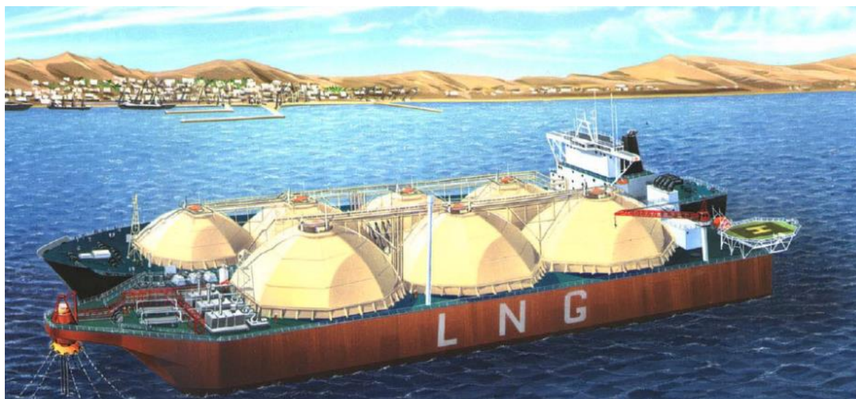
Slika 6. Plutajuće postrojenje za skladištenje i uplinjavanje LNG-a [10]
