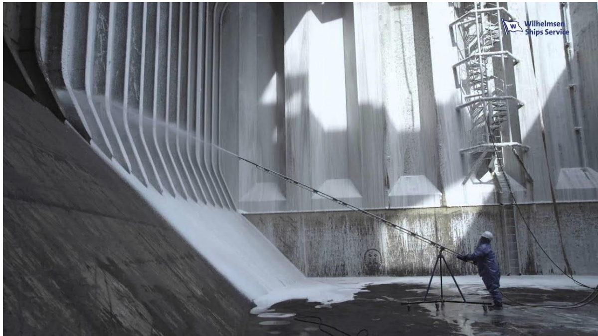
Slika 14. Postupak nanošenja kemijskih sredstava na stijenke broskog skladišta
