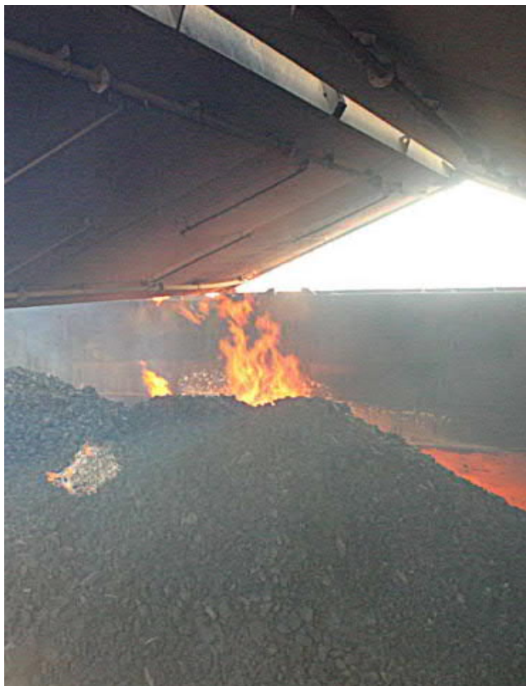
Slika 22. Požar u brodskom skladištu uslijed samozapaljenja ugljena
