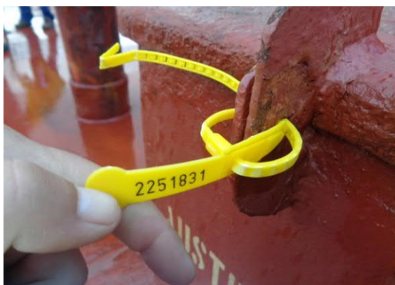
Slika 18. Sigurnosna plomba na ulazu u brodsko skladište
