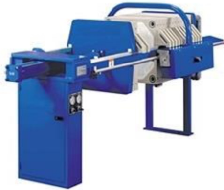
Slika 19. Uređaj za isušivanje sludgea . [10]
