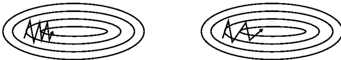
Slika 9. Klasični SGD algoritam (lijevo) i brža konvergencija zbog primjene SGD + momenta (desno) [27]
