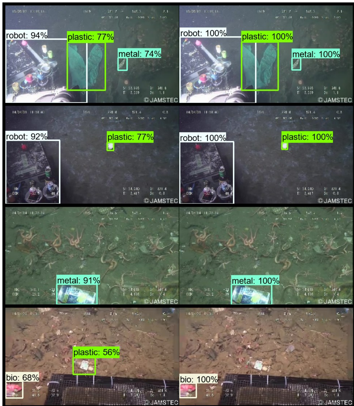
Slika 29. 4 primjera testnog skupa evaluirana na RetinaNet + ResNet-50 modelu
