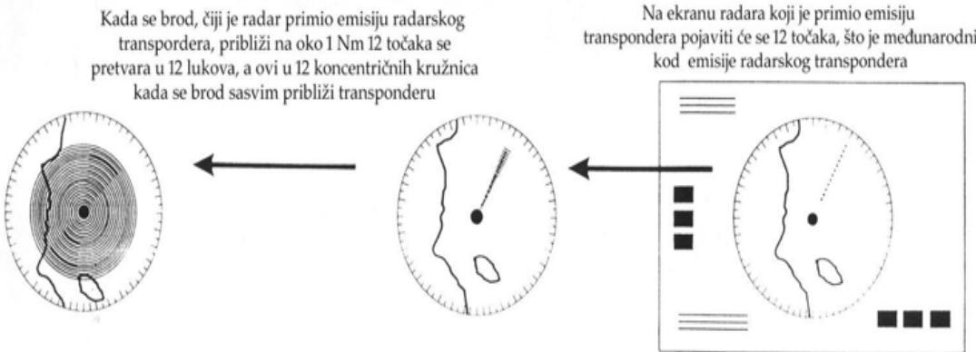
Slika 13. Prijem SART signala na brodskom radaru.
