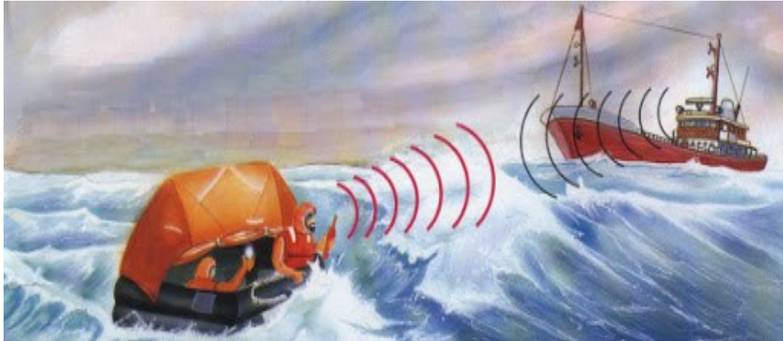
Slika 12. Emitiranje SART signala.
