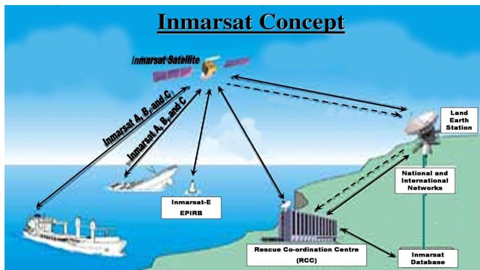
Slika 10. Uzbunjivanje uz pomoć radioplutače u Inmarsat sustavu.
