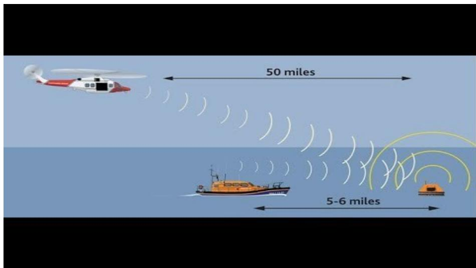
Slika 14. Udaljenost prijema signala (brod i letjelica).
