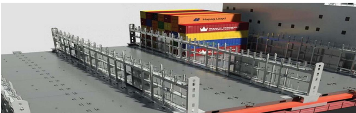
Slika 11.: Kontejnerski brod s „ Lashing bridge “ konstrukcijom na glavnoj palubi [12]
